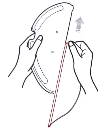
Примечание: Снимите модуль для мытья полов, если продукт не используется. Слейте воду, оставшуюся в емкости для воды и протрите тряпку, чтобы предотвратить появление плесени или запахов. Если зарядная док-станция находится на деревянном полу, всегда используйте влагонепроницаемый коврик, чтобы избежать попадания влаги на пол.
