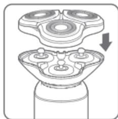
Примечание: Для обеспечения правильной работы электрической бритвы рекомендуется замена бритвенной головки раз в два года.
