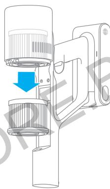
3. Промойте фильтр чистой водой, поворачивая фильтр на 360°, чтобы полностью удалить накопившуюся в нем пыль. Несколько раз слегка постучите по фильтру, чтобы убрать избыток грязи.
