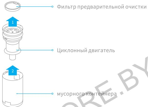
4. Тщательно промойте фильтр предварительной очистки, циклонный блок и контейнер для пыли водой, а затем отложите минимум на 24 часа для полной просушки.
