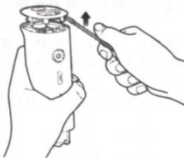
Извлечь механизм, с помощью ножниц обрезать соединительные кабели от аккумулятора к главной плате, снять аккумулятор.
