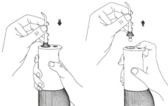
Для снятия насадки следует зажать кнопку разблокировки насадки и одновременно потянуть насадку вверх;
